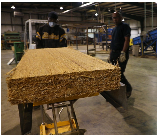
Scrimber. Walzen, auffasern und wieder verkleben von Holz zu tragenden Bauteilen. Bild: Grassbuilt, Meridian MS USA.
