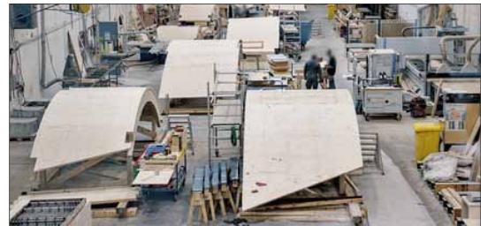
Die werkseitige Vorfertigung der Dachelemente in Aichach erfolgte in sechs Arbeitsschritten bis zur Verklebung der Abdichtungsbahn auf der Elementoberseite. Foto: Züblin Timber
