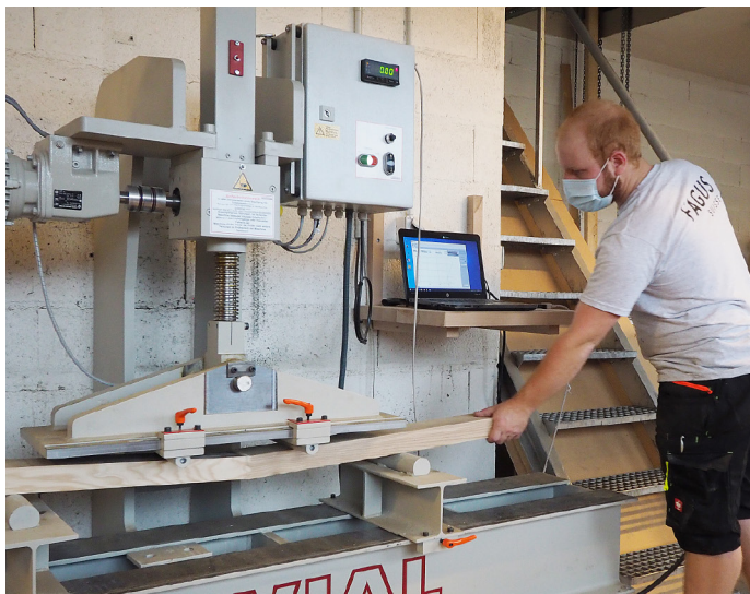
Qualitätskontrolle: Belasten bis das Brett bricht.
