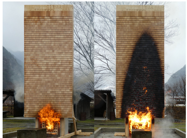
Ein Brandversuch der Schindelfassade
